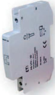
**Применение** - Дополнительные контакты PS STV предназначены для монтажа на боковую сторону разъединителя STV D02. Производятся в разных комбинациях, которые показаны ниже. Служат для сигнализации состояния разъединителя (включенного/выключенного положения). Ширина устройства составляет 9 мм, а остальные габаритные размеры совпадают с размерами разъединителя STV.
